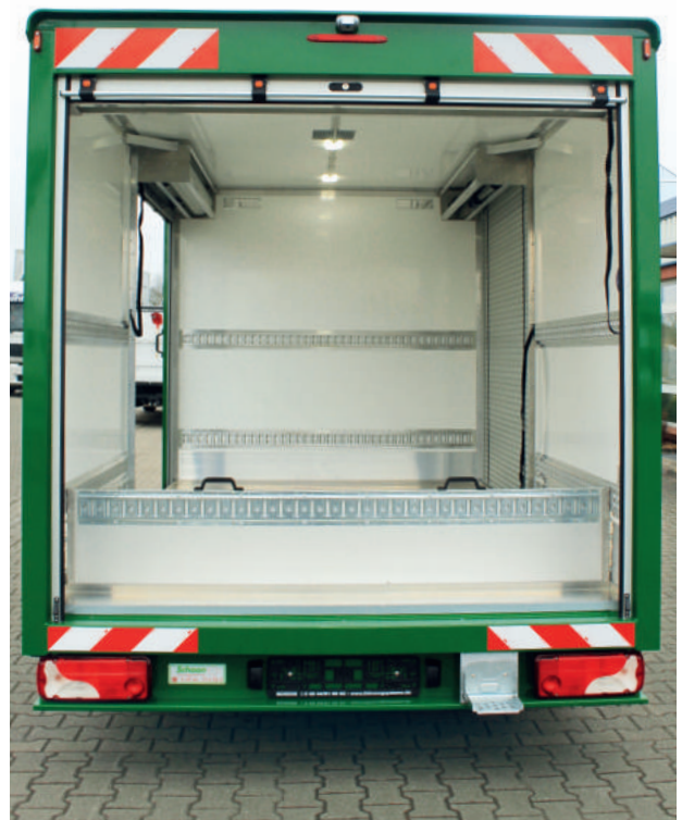
Schoon Tief-Koffer – sehr niedrige Beladehöhe Heck- und Seitenrollos ermöglichen schnellen Zugriff, Zurrleisten, Rückfahrkamera u.v.m.
