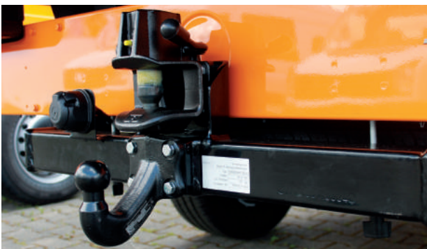
Kombi-System – Kugel- und Maul-Kupplung Nicht möglich bei Kastenwagen!
