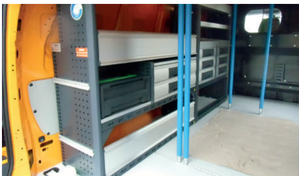
Sperrstangen und Zurrleisten am Boden zur Ladungssicherung
