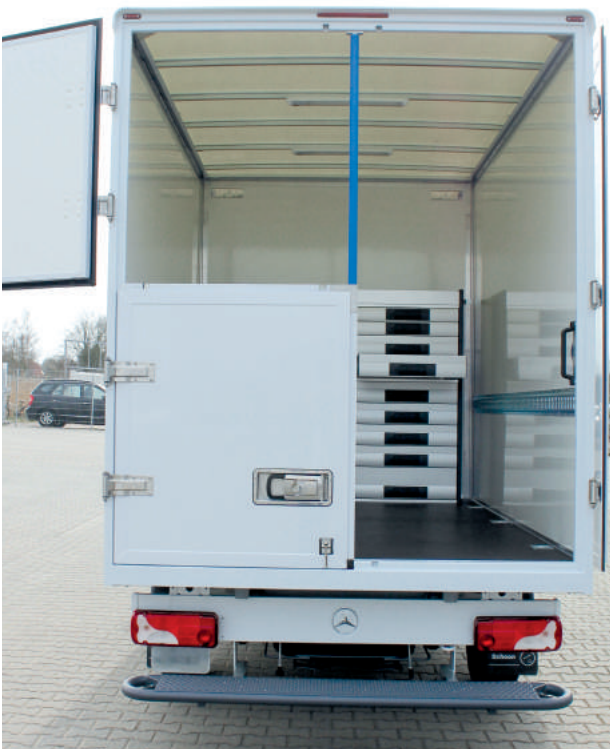
Schoon Koffer mit geteilten Heck-Flügeltüren Sperrstangen, Regalsysteme und Zurrleisten zur Ladungssicherung, gefederte Trittstufe u.v.m.
